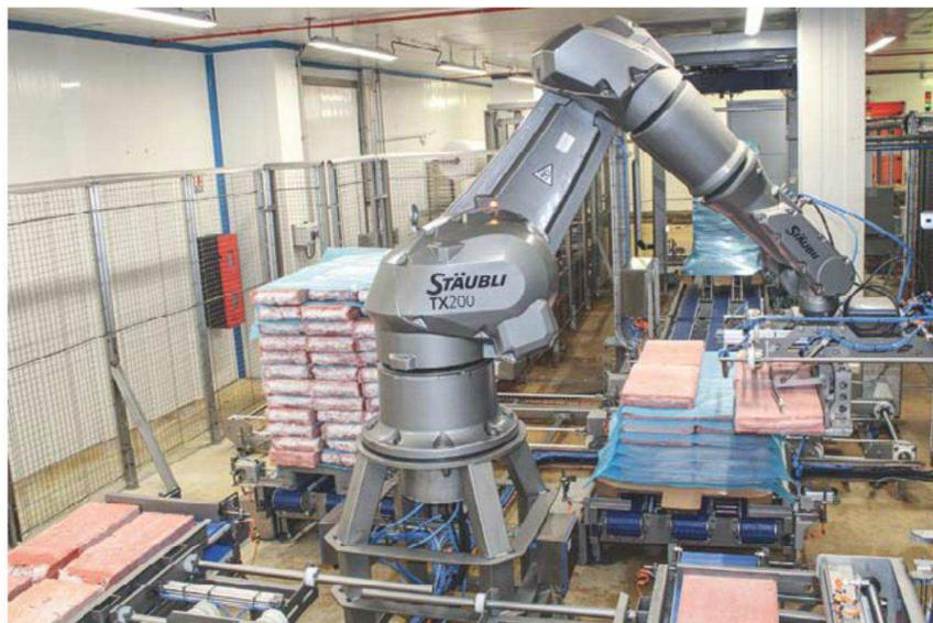
La ligne de palettisation conçue par Coaxial Technologie réalise six palettes par heure.
